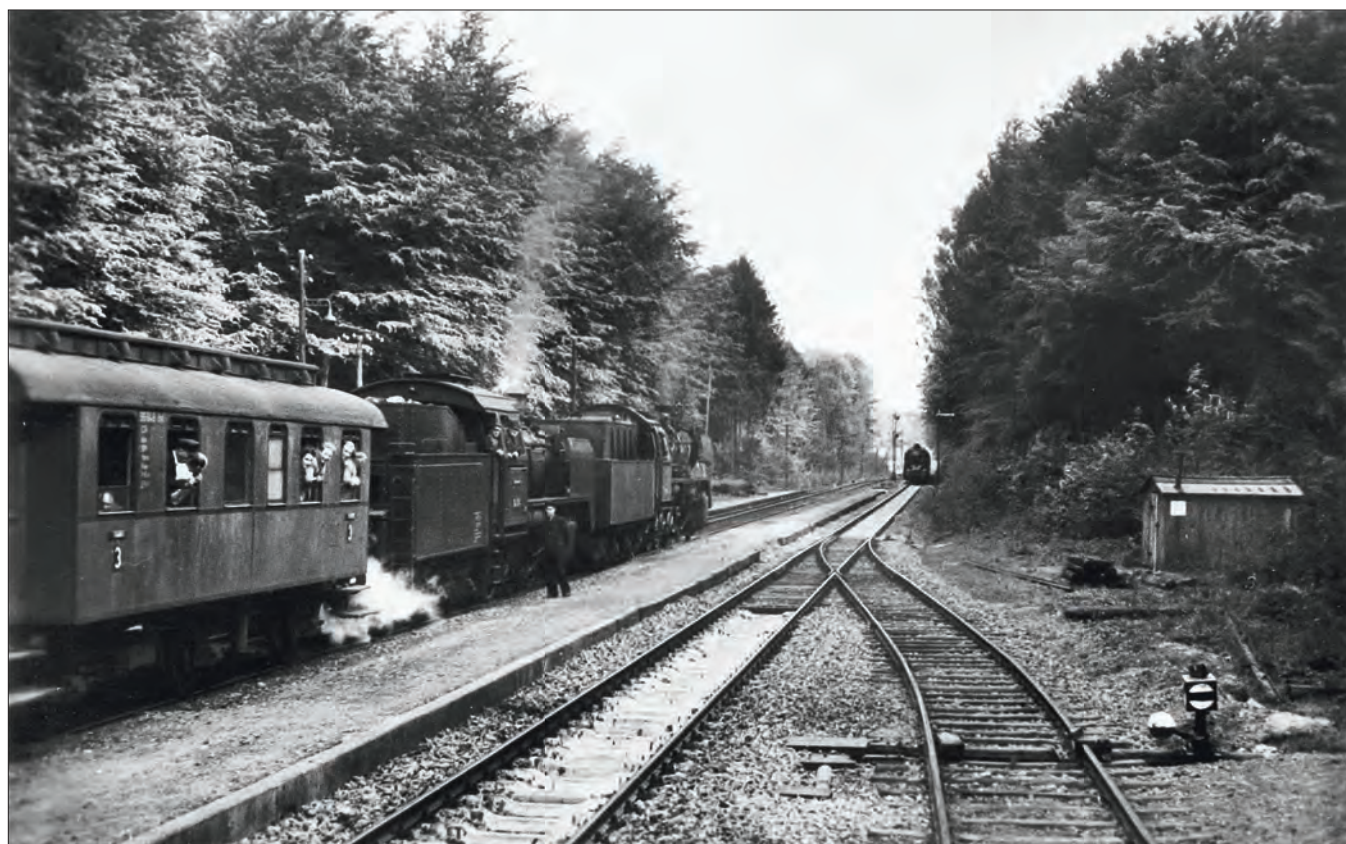
Auf Gleis 1 warten in Scharbeutz Lokomotiven der Baureihen 50 und 24 um 1954 vor einem Personenzug auf die Ausfahrt nach Lübeck. An der Spitze des Zuges läuft ein preußischer dreiachsiger Durchgangswagen mit Oberlicht der 3. Wagenklasse. Auf Gleis 2 fährt eine Lokomotive der Baureihe 50 ein. Das Ladegleis 3 wird durch eine Gleissperre gesichert.
