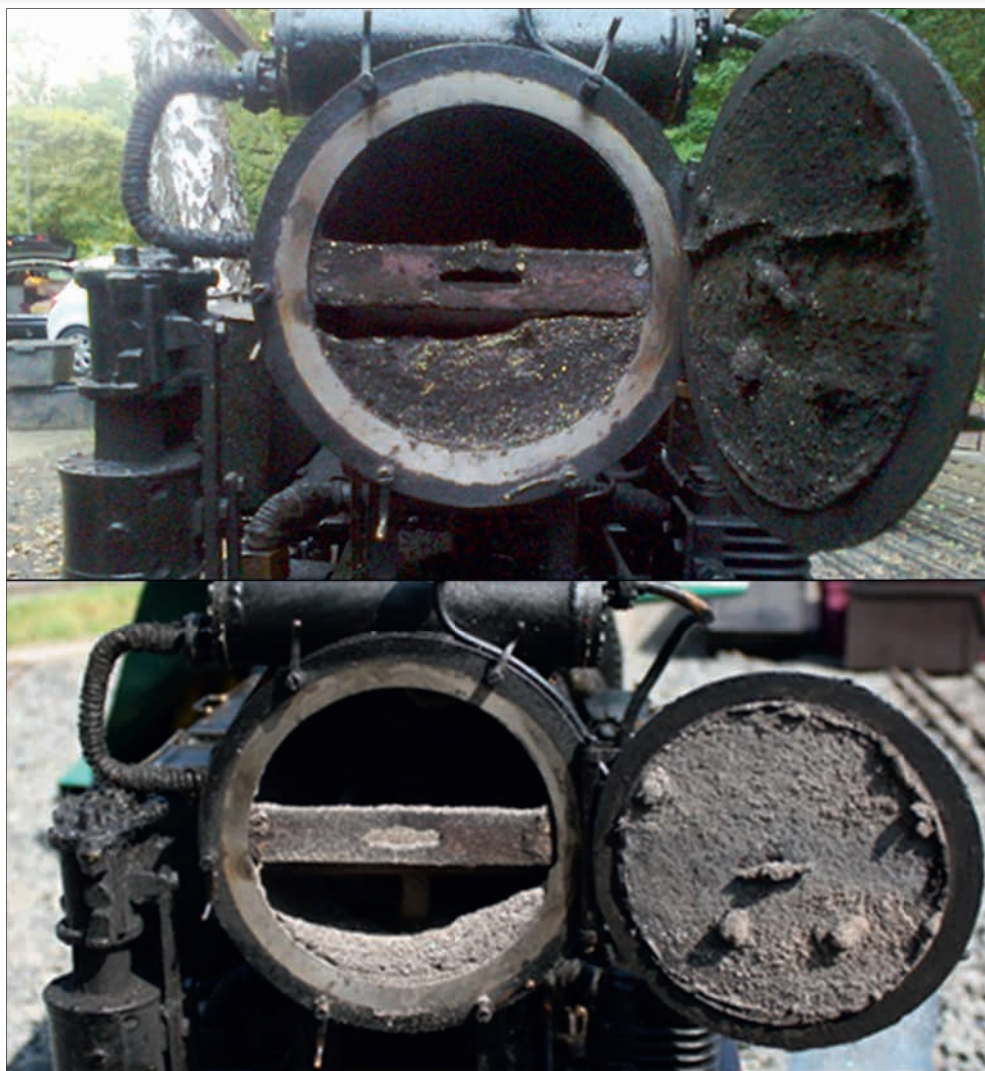
Abb. 7: Der direkte Vergleich der in die Rauchkammer mitgerissenen Partikel: Oben ist der Kessel ohne Feuerschirm und mit konventionellem Rost auf der Steinertseebahn betrieben worden. Unten findet sich nach einem anstrengenden Fahrtag in Oberursel tatsächlich nur vollständig Verbranntes in der Rauchkammer und davon auch deutlich weniger.
