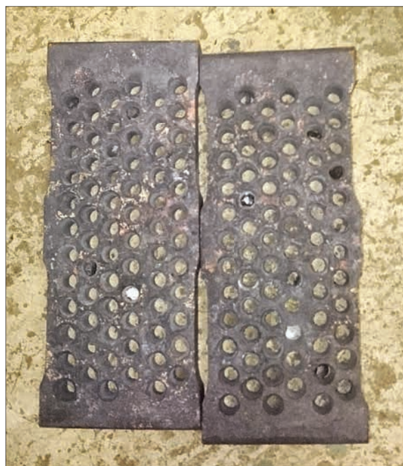
Abb. 6: Der Rost der „Fabia“ von Wilfried Wagner. Auf der Fläche von 145 x 120 mm sind 144 Löcher à 6,2 mm gebohrt. Das ergibt exakt 25 % freie Rostfläche. Wer die Lok kennt, erinnert sich an die diversen Zusatzaggregate, wie Lichtmaschine und Luftpumpe, die den Dampfverbrauch deutlich erhöhen. Die normalen Roste hielten nie lange, bis er auf die Idee mit der 16 mm starken Kupferplatte kam. Wer den Weisheiten dieses Artikels nicht traut, kann zumindest diese Anregung für einen dauerfesten Rost mitnehmen.
