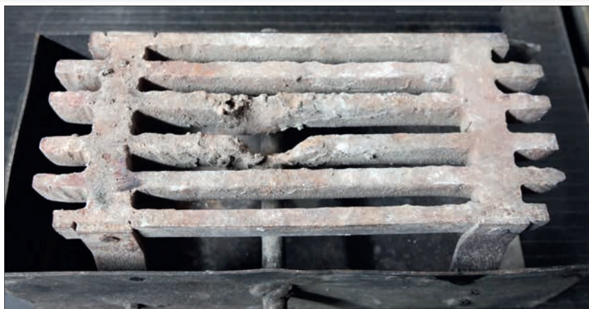
Abb. 4: Der Rost dieser 2' B „American“ in 7 1/4" hat es bald hinter sich. In der Mitte hat das Feuer den Grauguss-Rost kurzzeitig an seine Schmelztemperatur gebracht. Der Roststab hängt nach unten durch. Außen dagegen sind noch die Gussgrate vorhanden. Wenn Reifen ungleichmäßig abgefahren sind, beunruhigt uns das, beim Rost aber nicht?
